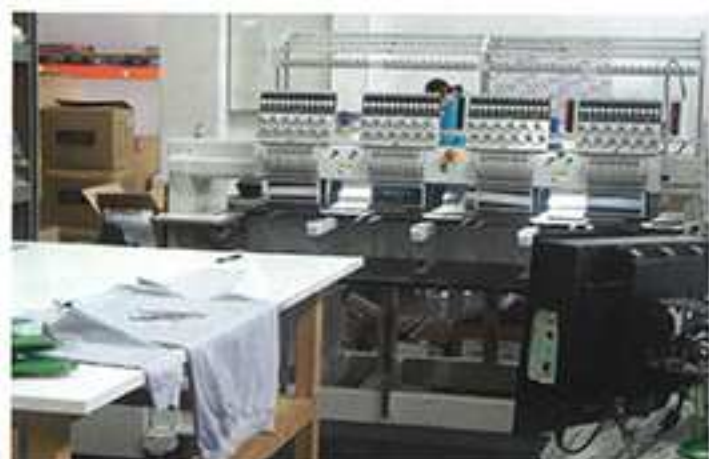
Die Stickerei bei ZEGO wurde 2012 durch eine 6-Kopf-Stickmaschine von Medlin erweitert.
