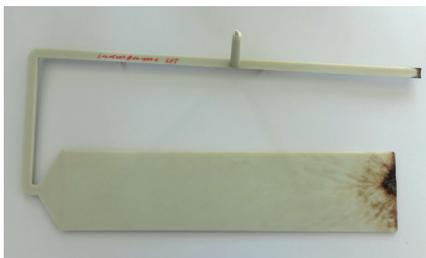
Brenner am Fließwegende eines faserverstärkten Bauteils – insbesondere faserverstärkte Thermoplaste neigen zu einer verstärkten „Gasbildung“
