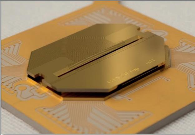
Quantenprozessor basierend auf einer segmentierten Ionenfalle, hergestellt via SLE-Verfahren.
